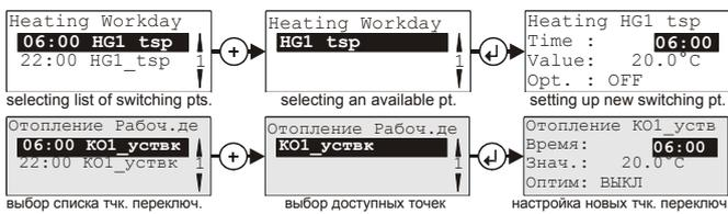
Рис. 60. Добавление точки переключения в дневную программу
